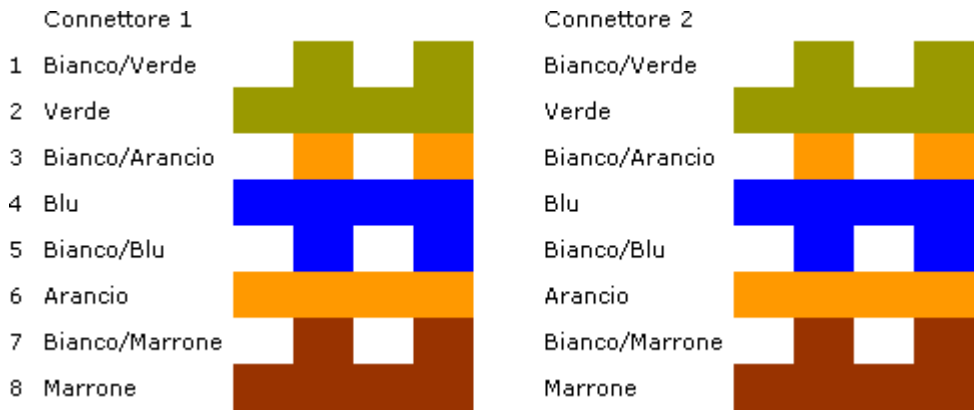
Figura 17.3: codici dei colori delle due spine nel cavo RJ45 CAT5 tipo Diretto.
