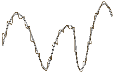
Figura 12.15: visione di un segnale sonoro come somma di una parte principale e di segnali a frequenza più elevata (armoniche secondarie).
