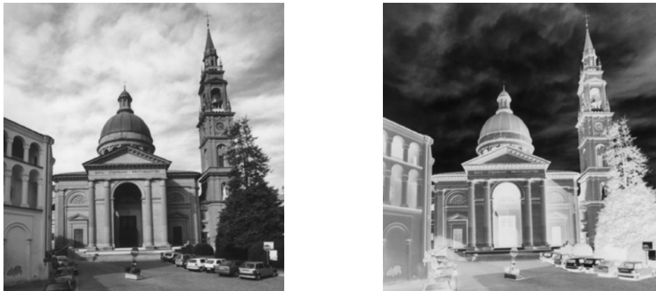
Figura 12.5: Immagini ad 8 bit, in cui ogni la luminosità di ogni pixel (elemento fondamentale componente l'immagine stessa) è rappresentata con un valore da 0 a 255. In particolare, a sinistra è la codifica diretta (0=nero, 255=bianco) e a destra l'applicazione della visualizzazione secondo la codifica inversa (0=bianco, 255=nero) alla stessa immagine, che risulta visualizzata in negativo.
