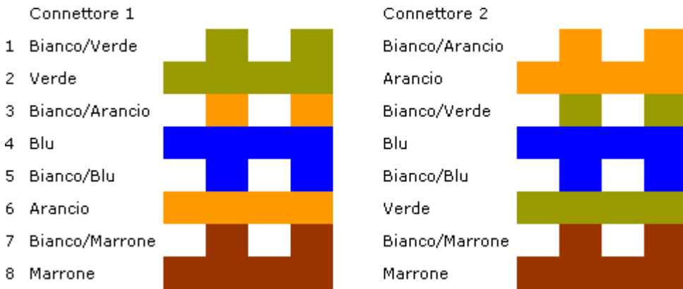
Figura 17.6: codici dei colori delle due spine nel cavo RJ45 CAT5 tipo Incrociato (Crossover)
